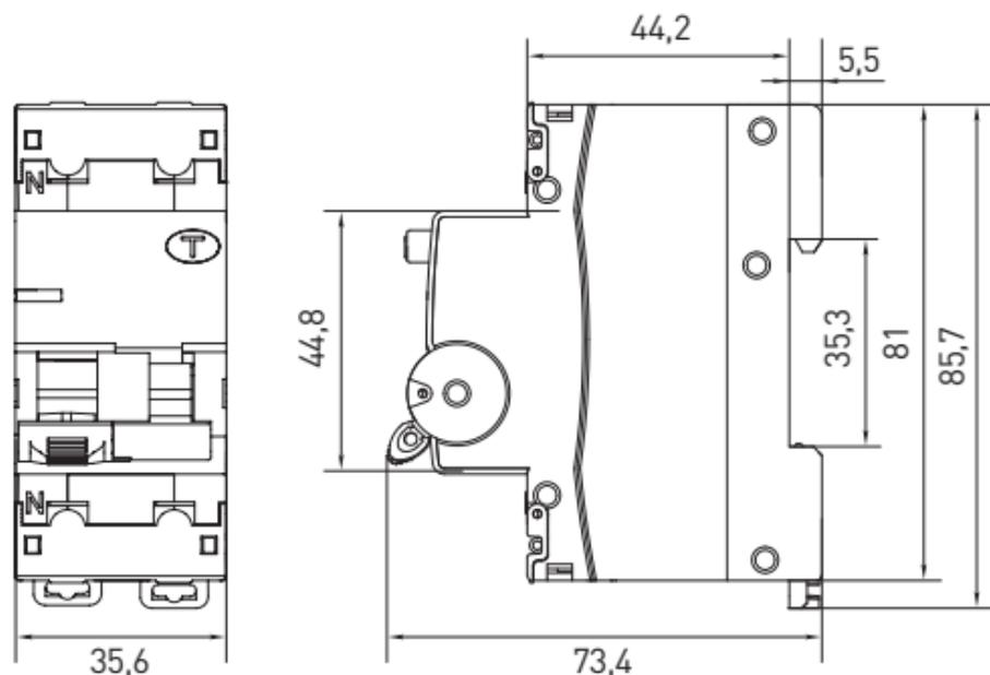
Рис. 3 – Габаритные размеры
