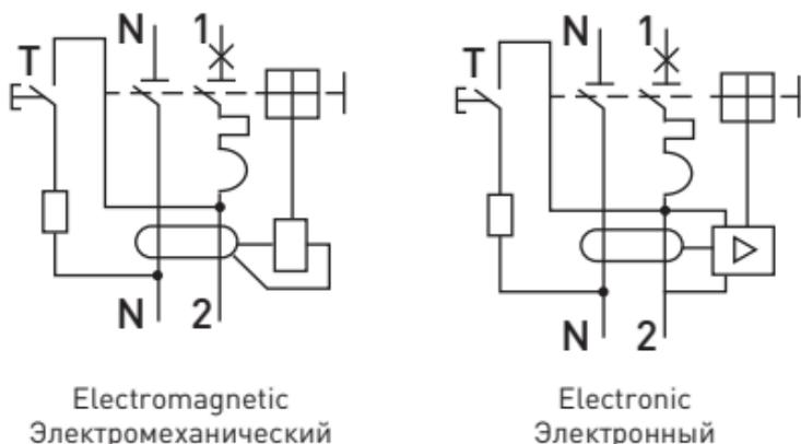
Рис. 4 – Типовые схемы подключения
