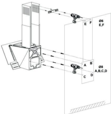
1] Просверлите отверстие Ø8 мм в стене, используя шаблон для установки, который находится в коробке вместе с монтажным оборудованием, (A,B,C,D) и вставьте пластиковые заглушки в эти отверстия Ø8 мм.
