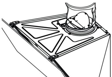
8) Перед соединением вытяжки с трубой проверьте пластиковые затворки на выходе вытяжки. Перед подсоединением к трубе включите вытяжку и убедитесь в том, что затворки двигаются вверх и позволяют воздуху выходить.
