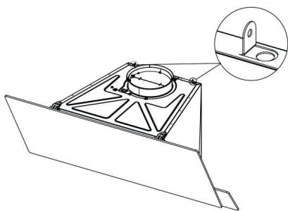
9) Протяните внутренний воздуховод вверх через внешний воздуховод и закрепите его винтом 3,5x6,5 RYSB на планке внутреннего патрубка дымохода, который вы ранее прикрутили к стене.
