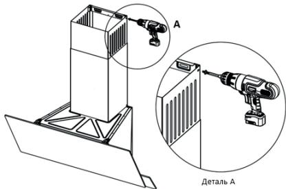
10) Закрепите внешний воздуховод на монтажном кронштейне воздуховода, который находится на верхней поверхности вытяжки (2 шт., справа-слева), используя болты 3,5x6,5 RYSB.
