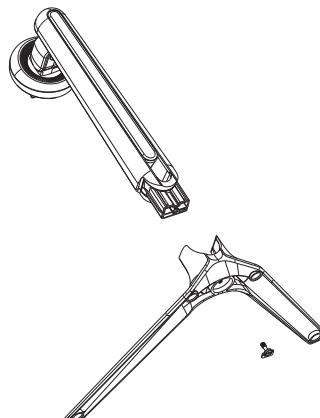
2. Положите монитор на ткань ЖК-панелью вниз, чтобы предотвратить повреждение ЖК-панели. Установите собранный корпус подставки в пазы задней части монитора до характерного щелчка.
