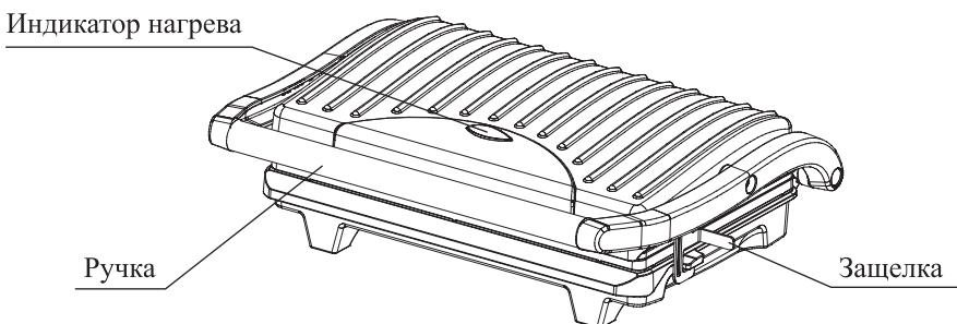
Индикатор нагрева загорается при подключении бутербродницы к сети электропитания. Когда рабочие поверхности прибора достигнут температуры, автоматически устанавливаемой встроенным термостатом, нагрев выключится, и индикатор нагрева погаснет. Затем нагрев будет периодически включаться для поддержания
