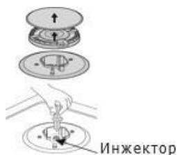
Снимите решетку, крышку конфорки и рассекатель пламени. Открутите инжектор, используя гаечный ключ на 7 мм, а затем установите вместо него инжектор, рассчитанный на подачу газа соответствующего типа. Аккуратно соберите все компоненты. После замены инжектор не необходимо зафиксировать.
