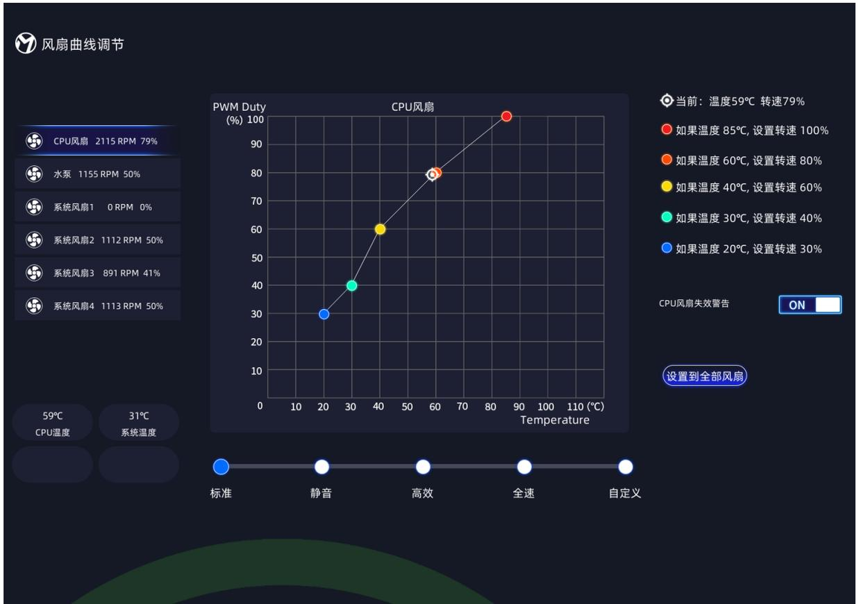
[风扇曲线调节] 界面可通过 [预览] 界面的 [风扇设置] 模块或 [状态] 界面的 [风扇设置] 模块进入，在此界面中，用户可设置安装在主板上的风扇曲线，可选择官方预设的 标准、静音、高效、全速 4个挡位，亦或者用户可以手动自定义风扇曲线。
