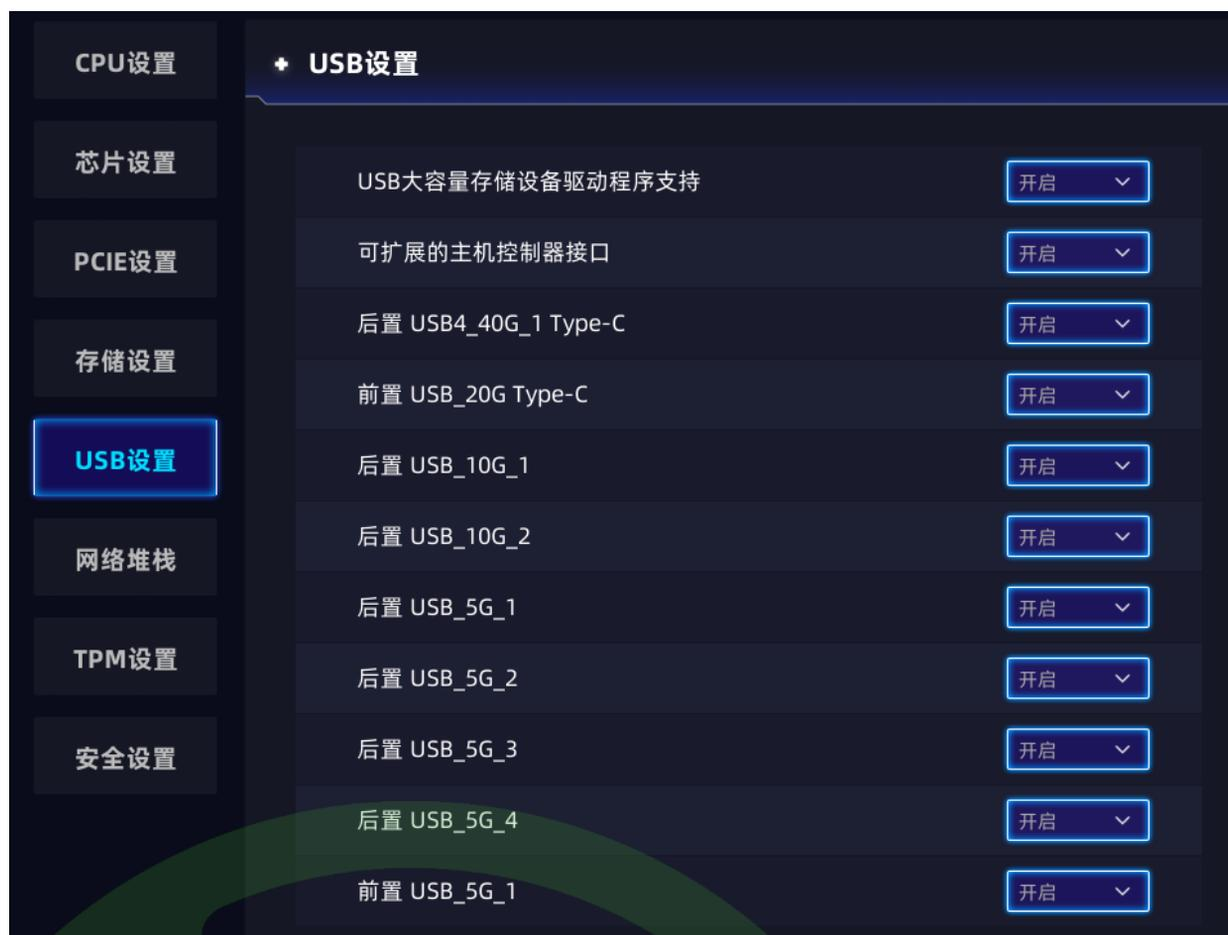
[USB大容量存储设备驱动程序支持]：开启/关闭 USB大容量存储设备驱动程序支持。
