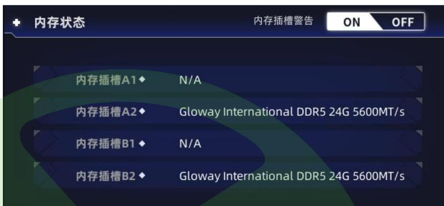
[内存状态] 模块中，可实时显示主板的内存槽上安装了什么内存，安装在什么插槽，并可以读取到简单的内存的SPD信息，界面右上角有[内存插槽警告]功能，开启后，系统在检测到内存没有安装在最佳插槽时，开机会自动进入BIOS并弹出提醒，如下图所示。
