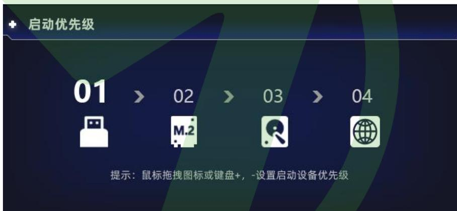
[启动优先级] 模块中，可调整设备第一启动优先级，可使用鼠标点击拖动图标或键盘 +/- 按键操作。
