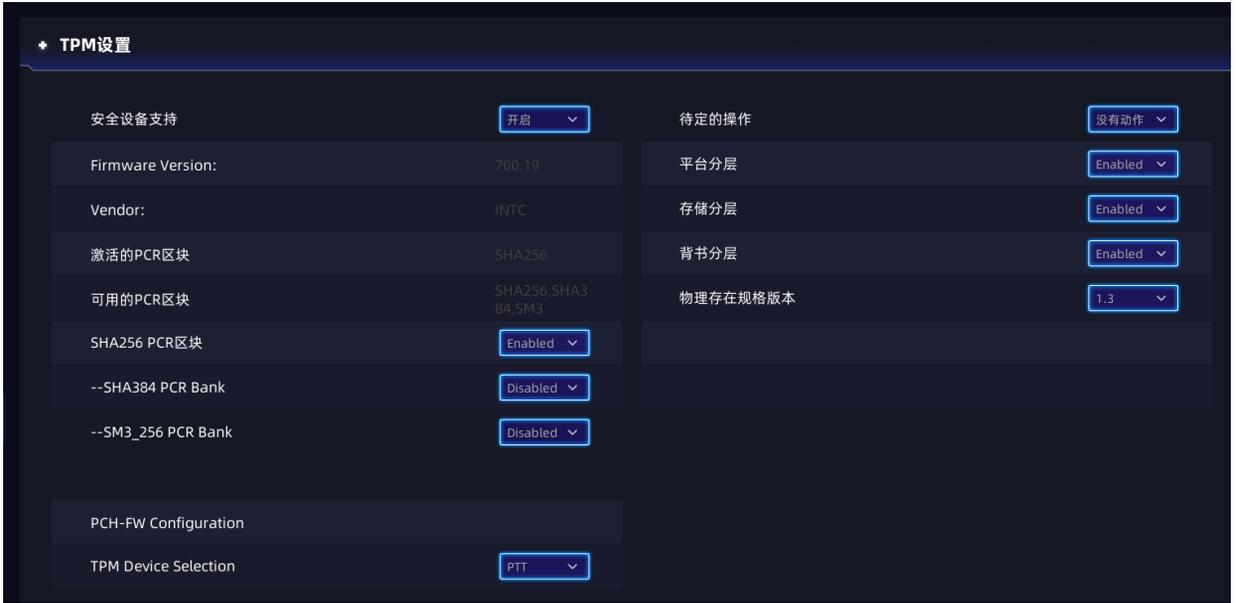
[安全设置支持]：开启/关闭 BIOS 对安全设备的支持，操作系统下不会显示安全设备。TCG EFI 协议和 INT1A 接口不可用。
