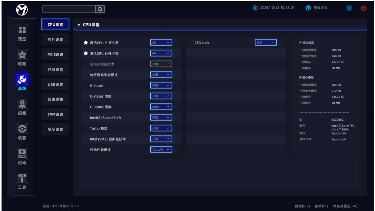
Advanced (高级) 界面一共分为8个子菜单，分别为 [CPU设置]、[芯片设置]、[PCI E设置]、[存储设置]、[USB设置]、[网络堆栈]、[TPM设置]、[安全设置]。
