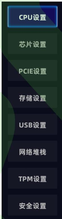
当BIOS选中光标停在主菜单的 [高级] 图标上的时候，使用键盘→键即可进图 [高级] 菜单的子菜单，使用键盘的↑↓键进行子菜单的选择，选中子菜单后再次使用键盘→键即可进入子菜单对应的功能选项区。
