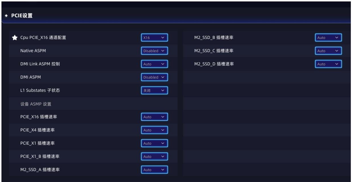
[Native ASPM]：选择 ASPM 电源控制方式。开启：由系统控制；关闭：由 BIOS 控制。
