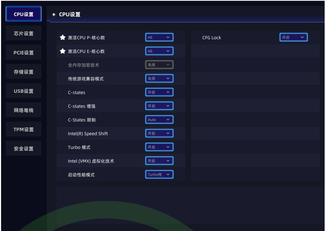
[激活CPU P-核心数]：每个处理器组中启用的 P-Core 核心数量。注意：P-Core 核心数量和 E-Core 核心数量是一起查看的。当两者都为{0, 0}时，将启用所有核心。
