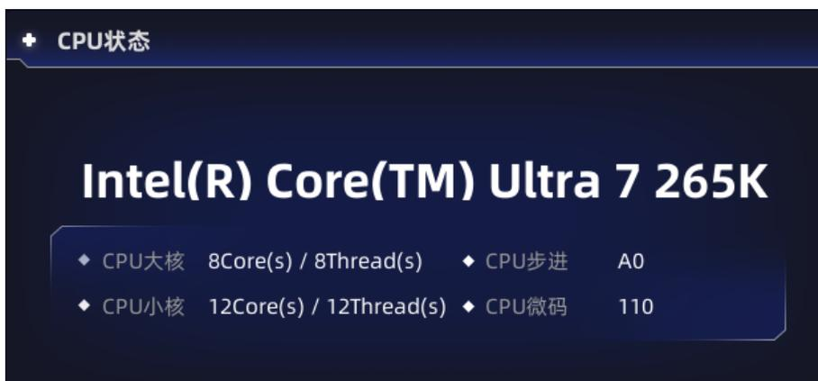
[CPU状态] 模块中，可显示当前所安装 CPU 的简单信息，如：CPU型号、大核核心/线程、小核核心/线程、CPU步进、CPU微码。
