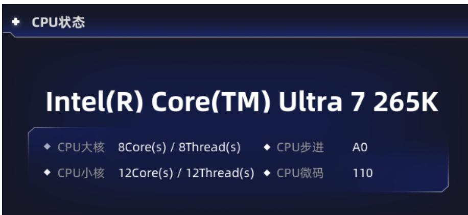
[CPU状态] 模块中，可显示当前所安装CPU的简单信息，如：CPU型号、大核核心/线程、小核核心/线程、CPU步进、CPU微码。
