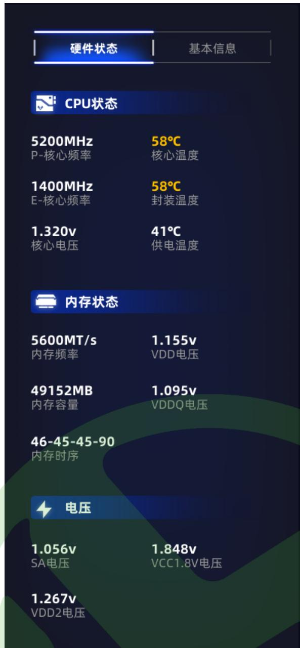
[硬件状态] 模块中，可实时显示当前主板的CPU、内存、电压等重要信息，包括频率、温度、内存时序和各种电压等。
