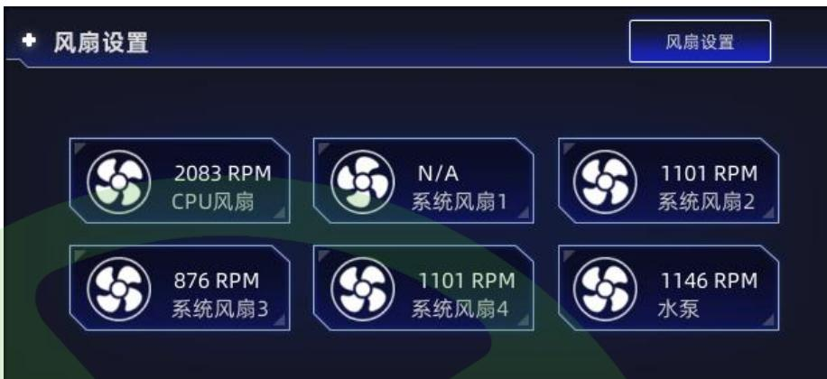
[风扇设置] 模块中，可实时显示当前安装在主板上的风扇转速情况，点击界面右上角的 [风扇设置] 按键，可进入 [风扇曲线调节] 界面。
