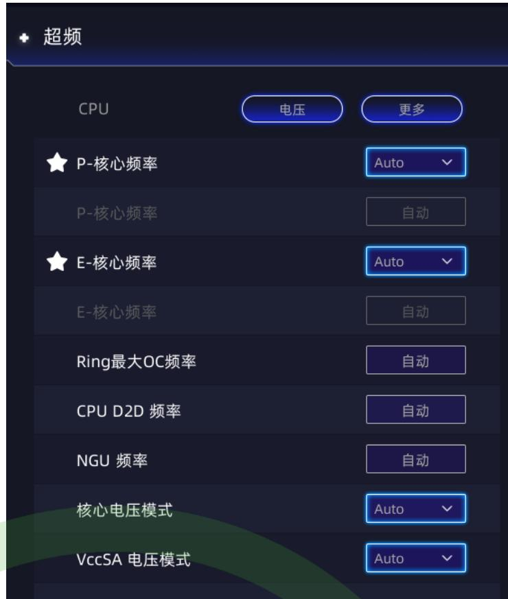
[P-核心频率]：P-核心频率设置。可选择设置[每个核心]或者[所有核心]。此选项随意设置可能会导致系统运行崩溃、硬件损害等现象，请谨慎操作。
