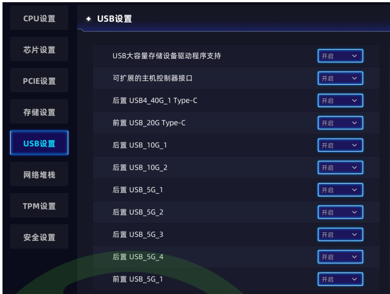
[USB大容量存储设备驱动程序支持]：开启/关闭 USB大容量存储设备驱动程序支持。
