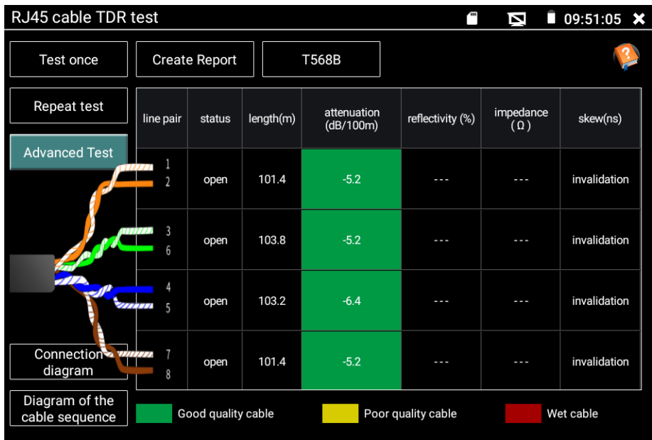
Рис. 103 Детальный тест кабеля (Advanced test)
