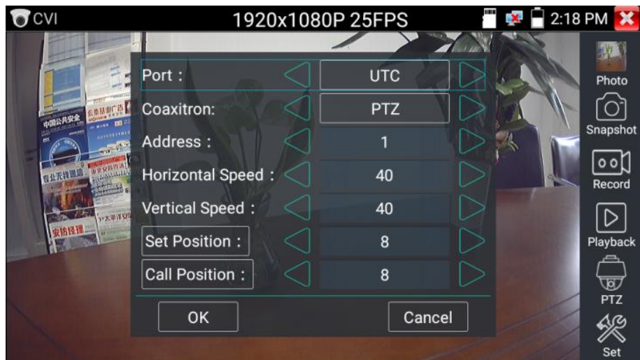
Рис.9 Настройки PTZ для видеокамер с UTC
