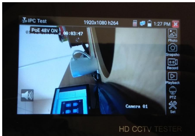
Рис. 17 Пример успешного подключения IP-видеокамеры к тестеру
