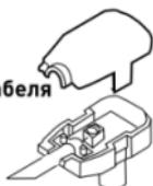
Подключение кабеля к сепаратору
