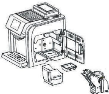
4. Полностью почистите пространство вокруг заварочного блока. Затем установите поддон на место.
