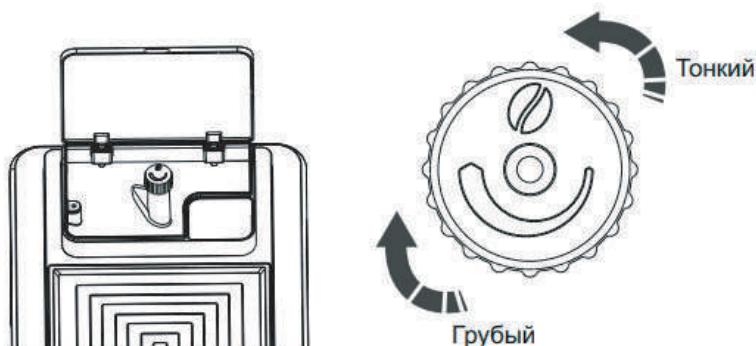
Для регулировки степени помола кофейных зерен воспользуйтесь регулировочным винтом, расположенным в отсеке для кофейных зерен.
