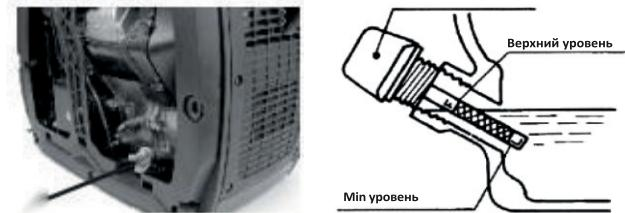
Снимите крышку маслозаливной горловины (щупа).
