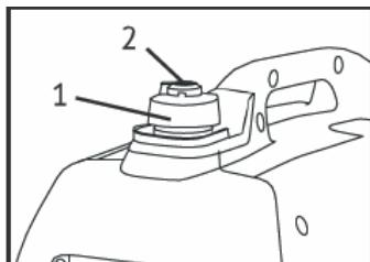
5. Многофункциональный выключатель поверните в положение ВКЛ («ON»).
