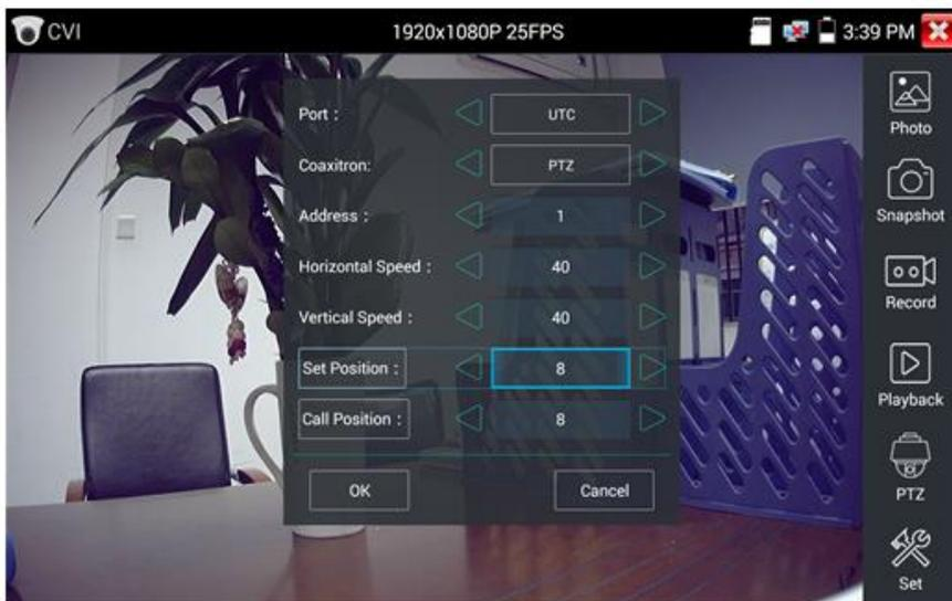
Рис.10 Настройки PTZ для видеокамер с UTC
