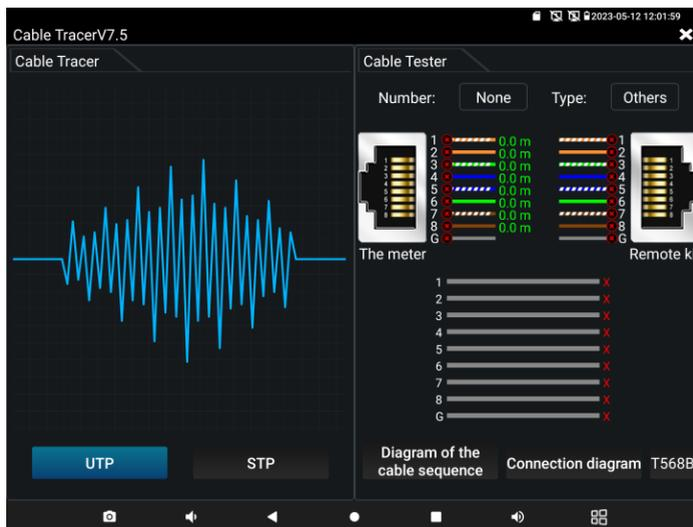
3) Подключите второй конец кабеля к разъему RJ-45 (4) для проверки корректности обжимки и прочих параметров. Тип текущей обжимки и состояние каждой пары в кабеле (есть контакт/нет контакта, длина пары проводников до 1,5км) будет отображено в правой части приложения в виде цветовой схемы.
