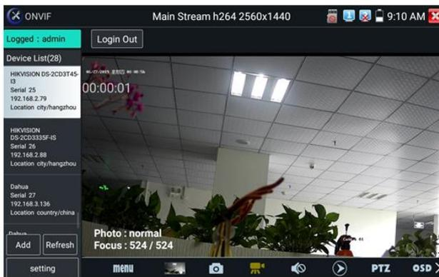
Рис. 18 Пример успешного подключения IP-видеокмеры к тестеру через ONVIF
