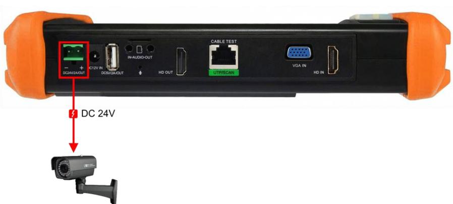
Видеокамера с питанием DC 24V
