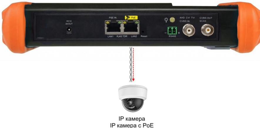
Рис. 11 Подключение IP-видеокамеры (на примере тестера TIP-H-7)
