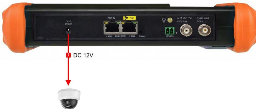
Видеокамера с питанием DC 12V
