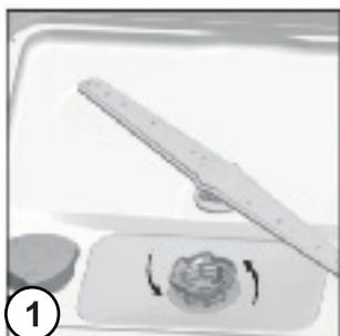
1. Поверните фильтр грубой очистки против часовой стрелки и потяните его вверх.
