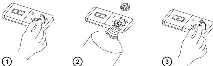
1. Откройте дозатор, поверните крышку в направлении стрелки (влево) и поднимите ее.
