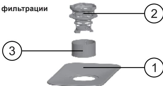
Система фильтрации состоит из фильтра грубой очистки, плоского (основного фильтра) и микрофильтра (фильтра тонкой очистки).
