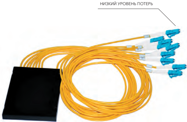
NTSS-FCT-FTB-1/8-9-SC/U-1.0-3.0 РАЗВЕТВИТЕЛЬ СПЛАВНОЙ 1X8ОКОНЦОВАННЫЙ SC/UPC 9/125 ВЫВОД 1М БУФЕР 3.0ММ 1310/1550
