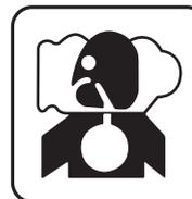
Выхлопные пары двигателя токсичны и могут привести к отравлению. Не запускайте двигатель и не оставляйте его работающим в помещениях и в положении, когда выхлопные пары могут попасть в органы дыхания людей и животных
