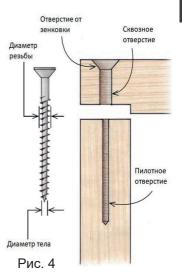
Первым сверлится пилотное отверстие, для соблюдения соосности в деталях. Затем в присоединяемой детали сверлится сквозное отверстие и производится его зенкование.
