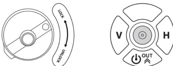
Клавиша Н управляет включением/отключением горизонтальной линии. Клавиша V отвечает за включение/выключение вертикальной линии, повторное нажатие включает вторую (у LP-62), третью и четвертую (у LP-64) вертикали. Лазерный отвес включается при нажатии кнопки V. Для работы с наклонными плоскостями при выключенном приборе нажмите кнопку OUT и проверните тумблер.
