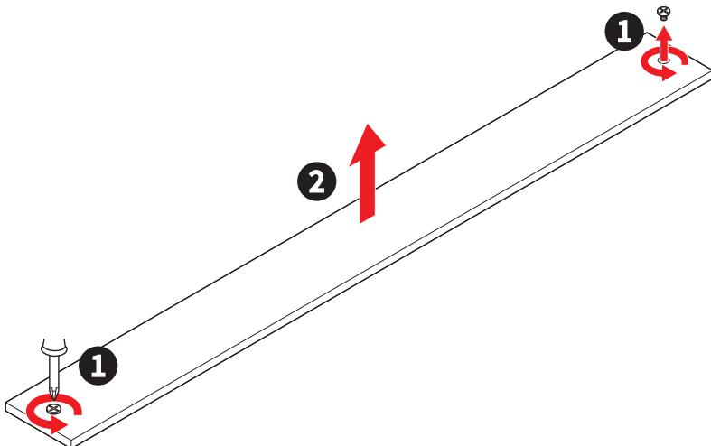
3. Если вы хотите установить SSD 2260 в слот M2\_3 или SSD 22110 в слот M2\_2, вместо этого установите **зажим EZ M.2 II** в отверстие 2260 или 22110. Обратите внимание, что для снятия и установки **зажим EZ M.2 II** необходимо использовать **инструмент для снятия зажима EZ M.2 II**. Пропустите этот шаг при установке 2280 SSD.
