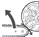
Будьте предельно внимательны и не подносите носок пильной шины до касания с предметом, это вызывает мгновенный обратный удар, при котором шина будет резко отброшена назад и вверх по направлению к оператору, в этом случае тормоз цепи автоматически активируется при достаточно сильной отдаче пилы – под действием инерции массы защиты руки. Защита руки перемещается вперёд к верхушке шины. Тормоз цепи работает только, если в конструкцию защиты руки не внесены изменения.
