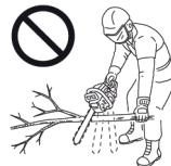
Допустимо работать этой моделью бензопилы, держа её в одной руке, только в случаях, когда оператор не имеет возможности дотянуться до места распила двумя руками. При этом он должен устойчиво разместиться, используя свободную руку, как опору.
