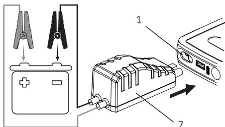
Убедитесь, что синий штекер адаптера полностью вставлен в порт пускового устройства. В противном случае синий штекер может быть оплавлен.
