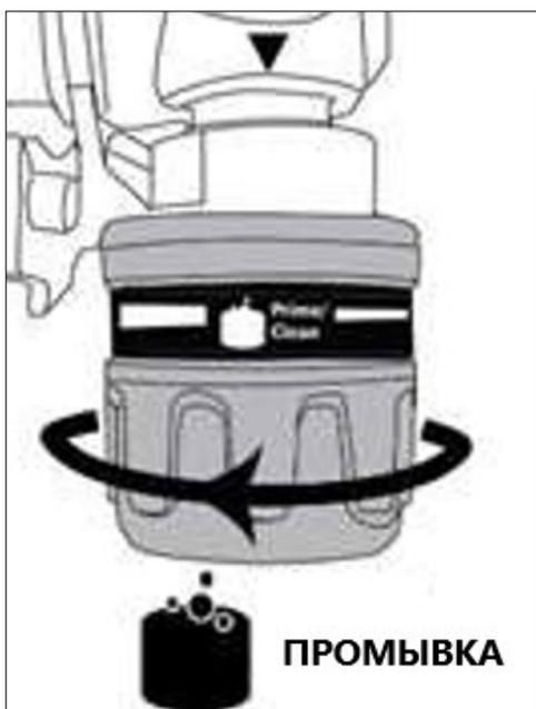
Рис. 13. Режим «промывка» на регуляторе давления
