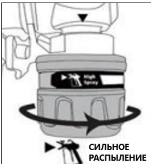
Рис. 19. Максимальное значение на регуляторе давления
