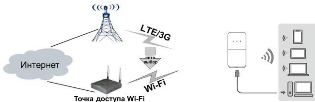
Рисунок 3-3 Автоматическое переключение между сетями LTE, 3G и Wi-Fi
