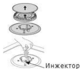
Снимите решетку, крышку конфорки и рассекатель пламени. Открутите инжектор, используя гаечный ключ на 7 мм, а затем установите вместо него инжектор, рассчитанный на подачу газа соответствующего типа. Аккуратно соберите все компоненты. После замены инжектор необходимо надежно зафиксировать.
