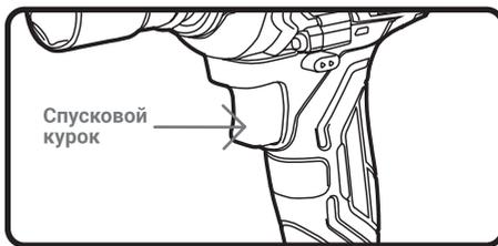
спусковой курок выключателя и возвращается в положение "ВЫКЛ" при отпускании. Чтобы запустить инструмент, просто нажмите на спусковой курок выключателя. Скорость вращения инструмента увеличивается за счет увеличения давления на спусковой курок выключателя. Отпустите спусковой курок переключателя до упора.
