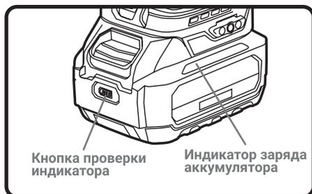
Нажмите кнопку проверки на батарейном отсеке, чтобы указать оставшуюся емкость аккумулятора. Контрольные лампы загораются на несколько секунд.
