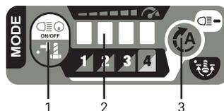
Цифра «1» указывает на кнопку переключения скорости / светодиодную кнопку. Длительное нажатие кнопки «1» для включения/выключения рабочей подсветки на 20 мин.
