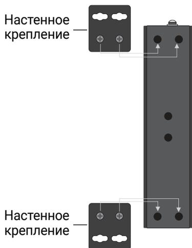
2. С помощью винтов закрепите коммутатор вертикально на стене
