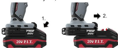
Чтобы извлечь аккумуляторную батарею, нажмите на кнопку разблокировки и извлеките аккумулятор из электроинструмента.
