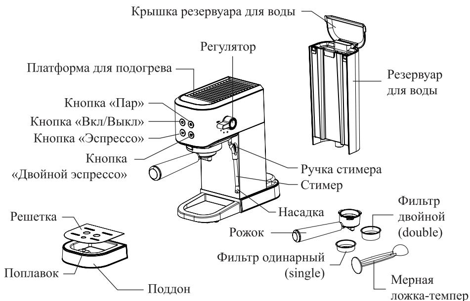
**Кнопка «Вкл/Выкл»** включает и отключает кофеварку. После нажатия на кнопку «Вкл/Выкл» выполняется нагрев бойлера, индикатор кнопки «Вкл/Выкл» горит непрерывно, а индикаторы кнопок «Эспрессо» и «Двойной эспрессо» мигают. Когда кофеварка достаточно нагреется для приготовления эспрессо или подачи горячей воды, индикаторы кнопок «Эспрессо», «Двойной эспрессо» и «Вкл/Выкл» будут гореть непрерывно.
