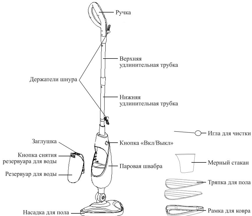
Принцип работы паровой швабры достаточно прост. Вода из резервуара подается помпой (водяной насос) в заранее прогретый до высокой температуры бойлер. В бойлере вода моментально преобразуется в пар и выходит из сопла.
