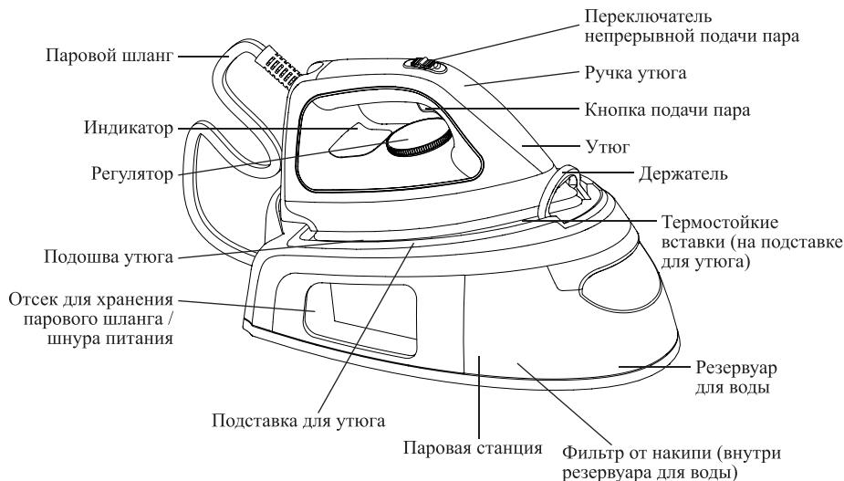
Принцип работы паровой станции прост: вода из резервуара с помощью помпы подается по шлангу в утюг, где расположена бойлер. В бойлере под воздействием высокой температуры вода превращается в пар и под давлением выходит из паровых сопел утюга.
