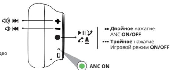
Рис. 3. Функции кнопок
