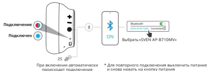
Рис. 2. Включение питания и подключение
