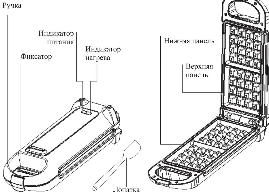
Индикатор питания загорается при включении вафельницы. Индикатор нагрева горит в то время, когда вафельница разогревается. Когда рабочие поверхности достигнут температуры, определяемой термостатом, нагрев выключится, и индикатор нагрева погаснет. Затем нагрев будет периодически включаться для поддержания температуры, в это время индикатор нагрева будет гореть. Таким образом, в процессе приготовления индикатор нагрева периодически загорается и гаснет.
