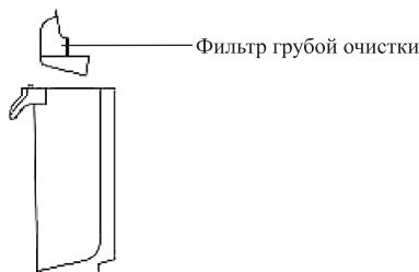
4. Очистите резервуар, крышку и фильтр грубой очистки без использования моющих средств. Полностью просушите все части резервуара для грязной воды естественным путем.
