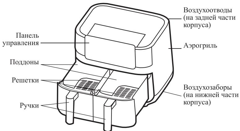
Принцип работы аэрогриля основан на конвекции воздушных потоков от нагревателей внутри рабочей емкости. Вентиляторы, расположенные в верхней части аэрогриля, приводят в движение воздушные массы, нагретые до высокой температуры ТЭНами (трубчатыми электронагревателями). Горячий воздух циркулирует внутри рабочей емкости аэрогриля и нагревает продукты до нужной температуры.
