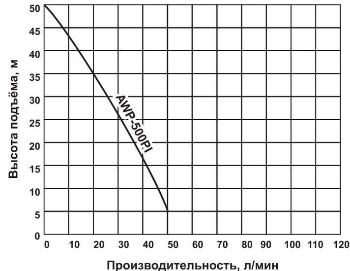
**Рисунок А** — График зависимости производительности насосной станции AWP-500PI от высоты подъема воды
