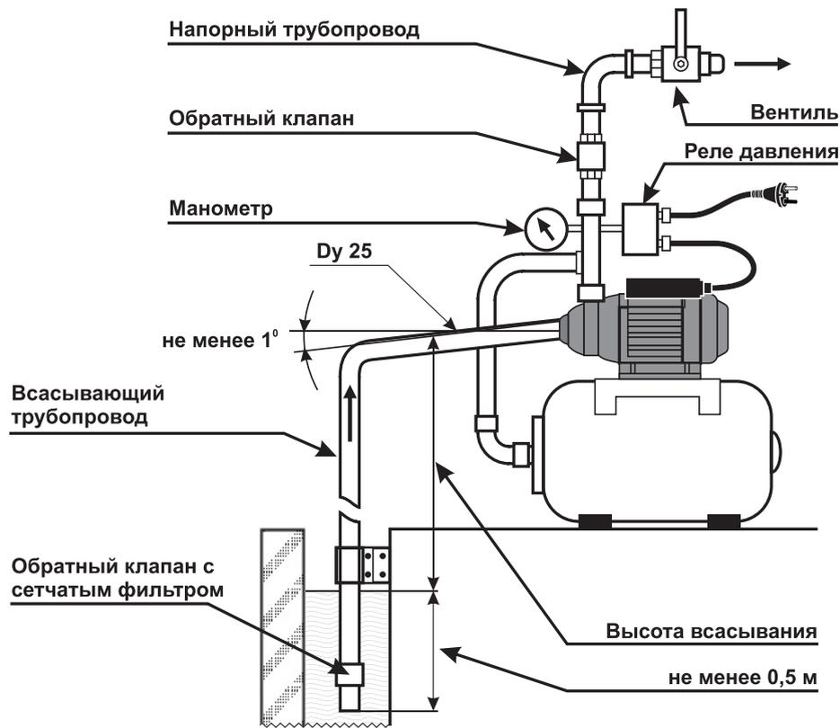
**Примечание** — схема может не отражать особенности конструкции насосной станции AWP-500PI.
