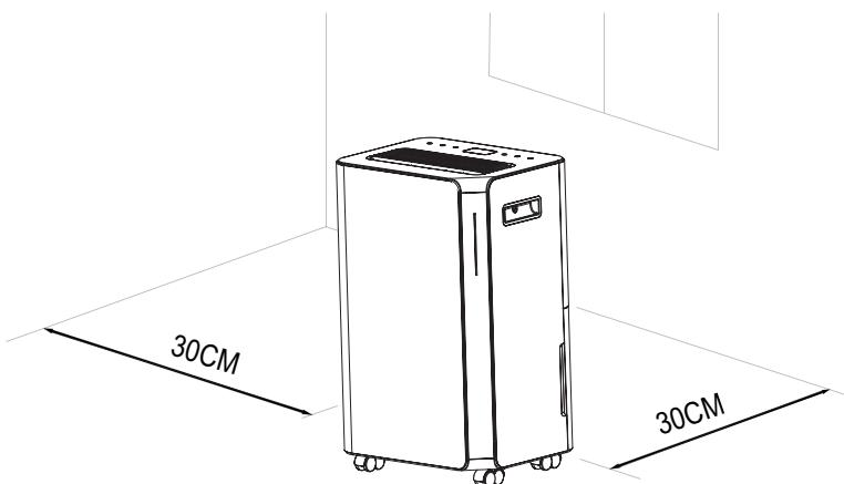
**ПРИМЕЧАНИЕ:** Для упрощения перемещения осушитель снабжен колесиками. Не следует передвигать прибор по коврам или через какие-либо предметы, иначе это может привести к проливанию воды из контейнера или блокировке колес.
