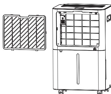
2. Пропылесосьте поверхность фильтра или промойте под теплой водой без применения агрессивных и чистящих средств.
