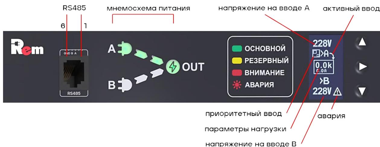
Рис. 1. Управляющий модуль АВР
