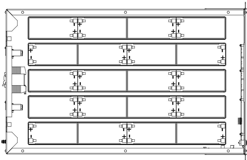
Рисунок 3 – Размещение аккумуляторных батарей в корпусе
