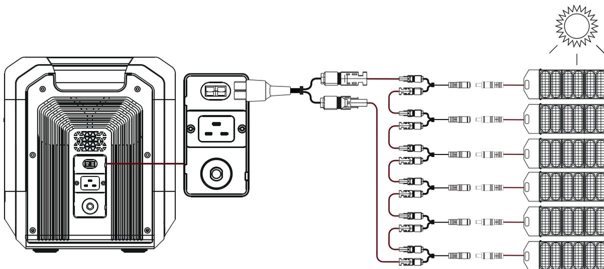
Для зарядки портативной электростанции с помощью солнечных панелей, соедините несколько солнечных панелей с помощью коммутационного кабеля (Y) с коннектором HPP Anderson и подключите к входному порту HPP Anderson (14).
