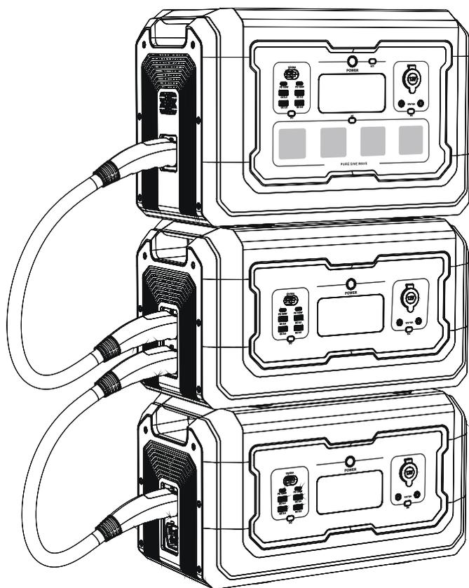
После подключения включите портативную электростанцию и дополнительную батарею. На экране портативной электростанции отобразится индикатор подключения дополнительной батареи и количество подключенных дополнительных батарей.
