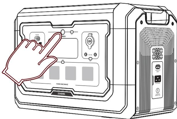
Для выключения портативной электростанции нужно нажать и удерживать в течение 3 секунд кнопку управления портативной электростанцией. Подсветка кнопки и LCD экран выключатся одновременно.
