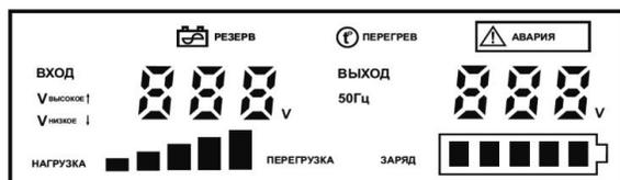
Рисунок 3 — Светодиодный графический индикатор.
