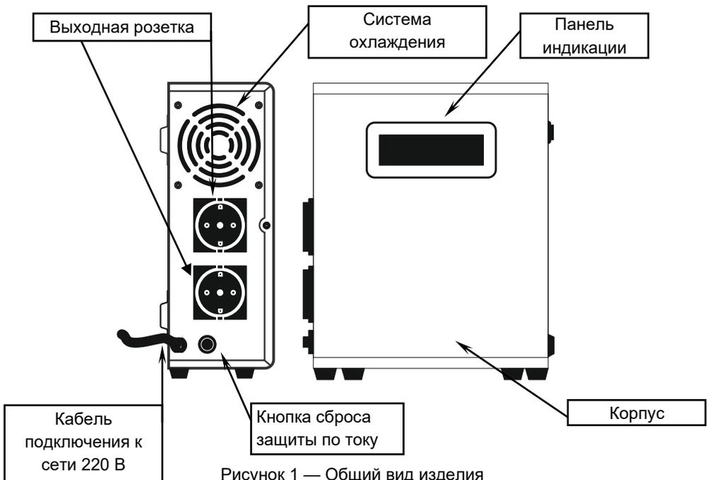
На левой стенке корпуса изделия размещены: автоматический предохранитель с кнопкой сброса защиты при его срабатывании, кабель подключения к источнику напряжения 220 В, две выходные розетки и система охлаждения, представленная вентиляционными отверстиями и кулером (см. рисунок 1).
