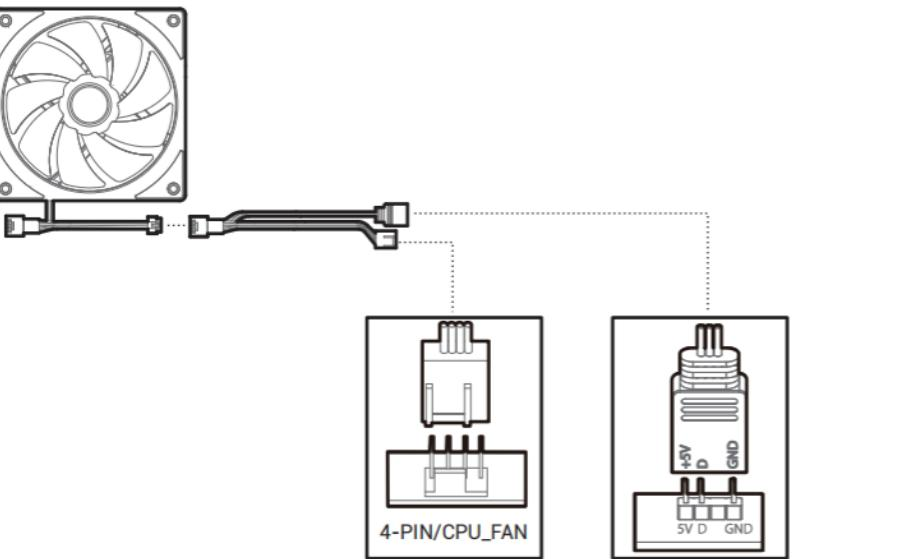
本产品最多支持四把风扇连接使用,请勿超出连接数量以免造成电流过载损坏相关设备。
