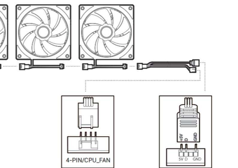
本产品最多支持四把风扇连接使用,请勿超出连接数量以免造成电流过载损坏相关设备。
