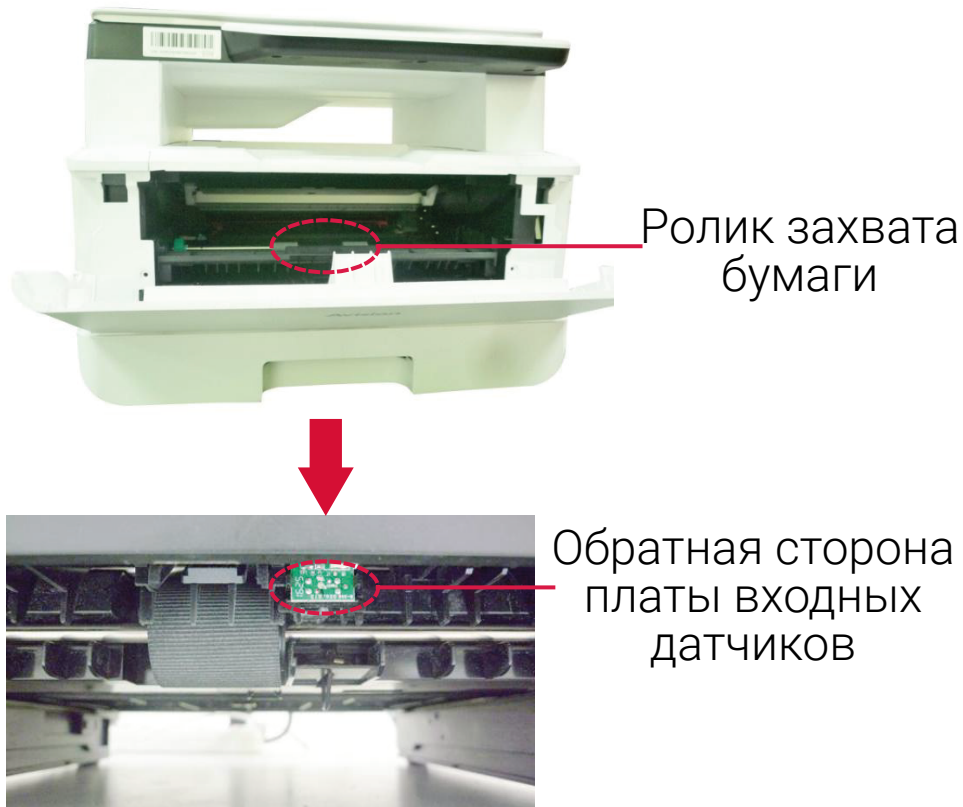
Рисунок 41 – Очистка входных датчиков бумаги
