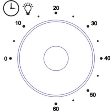
Поворачивая ручку по часовой стрелке, установите нужное время приготовления. На панели управления печкой загорится индикатор работы, а в камере печи загорится лампочка подсветки.
