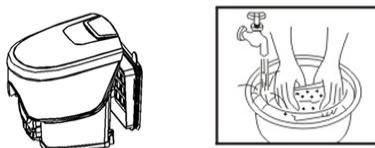
При сильном загрязнении промойте его прохладной водой под краном. Запрещается мыть фильтр горячей водой или использовать для его мытья моющие средства.
