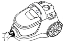
1. Выровняйте гибкий шланг относительно воздуходоборного отверстия и прижмите до фиксации.
