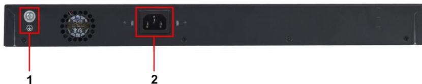
Рис.3 Коммутатор SW-8244/LST(370W), разъемы на задней панели
