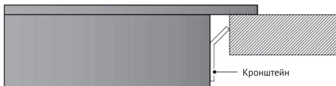
⚠ Ни при каких обстоятельствах после установки кронштейны не должны соприкасаться с внутренней поверхностью столешницы (см. рисунок).
