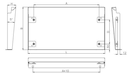
Крыша может крепиться совместно с кронштейнами для навески на столб EMW-ККС через отверстия в задней части.
