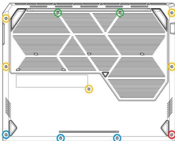
3. С помощью пластикового лезвия откройте указанную область нижней крышки, как показано на рисунке ниже.
