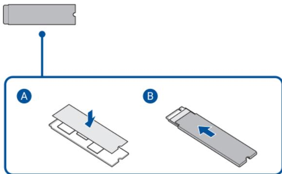
3. Выровняйте и вставьте модуль(и) M.2 SSD в разъемы M.2, затем закрепите модуль(и) на материнской плате с помощью открученных ранее винтов.
