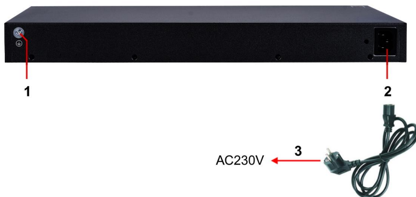
Рис.10 Подключение коммутатора к сети AC230V
